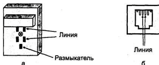
Рис. 10.4. Розетки для телефонных линий: а — стандарт бывшего СЭВ, б — международный стандарт
