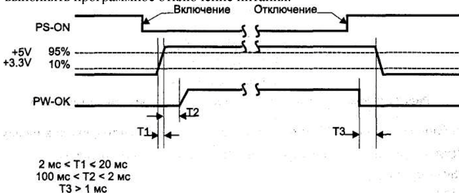
Рис. 13.8. Временная диаграмма интерфейса управления питанием АТХ
